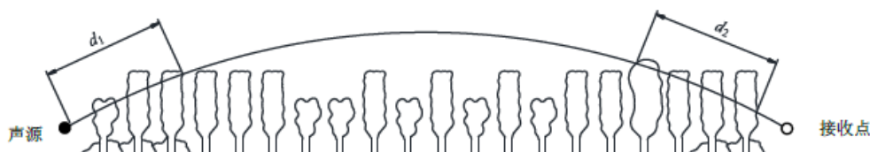
图 5.1-2 通过树和灌木时噪声衰减示意图
